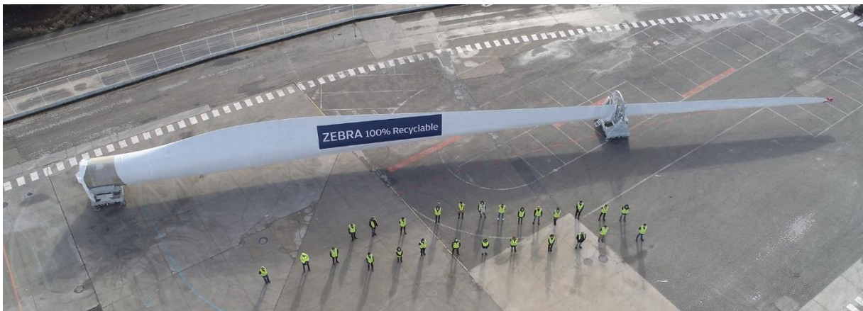
Légende : Pale d'éolienne Zebra longueur 62m 100% recyclable – Crédit image : LM Wind Power
